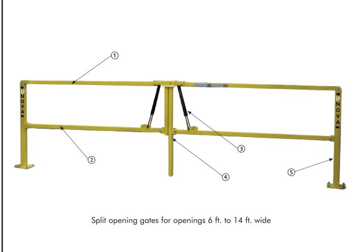
1 – UPPER GUARDRAIL 2 – LOWER GUARDRAIL 3 – DUAL GAS STRUTS 4 – CENTER SUPPORT 5 – BOLLARD
